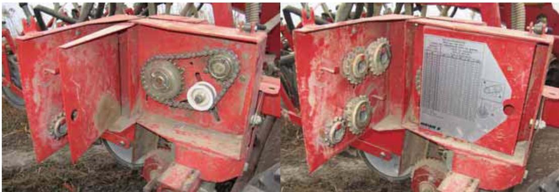
**Fig. 3.** Engranajes para regular la densidad de siembra
