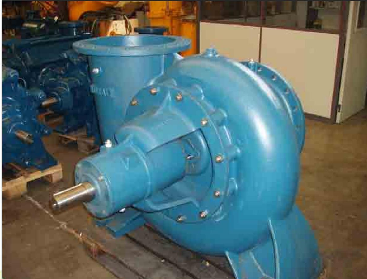
**Bomba centrífuga horizontal de carcasa tipo voluta y rodete de simple aspiración (DIN 24255)**
